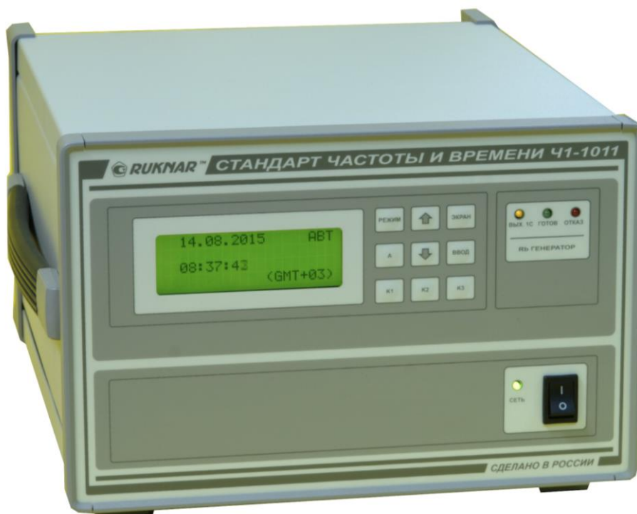
Рисунок 4.1а – Внешний вид стандартов частоты и времени рубидиевых Ч1-1011 и Ч1-1011/2.
