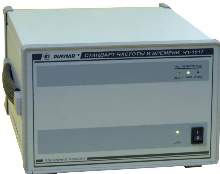
Рисунок 4.1б – Внешний вид стандартов частоты и времени рубидиевых Ч1-1011/1 и Ч1-1011/3.
